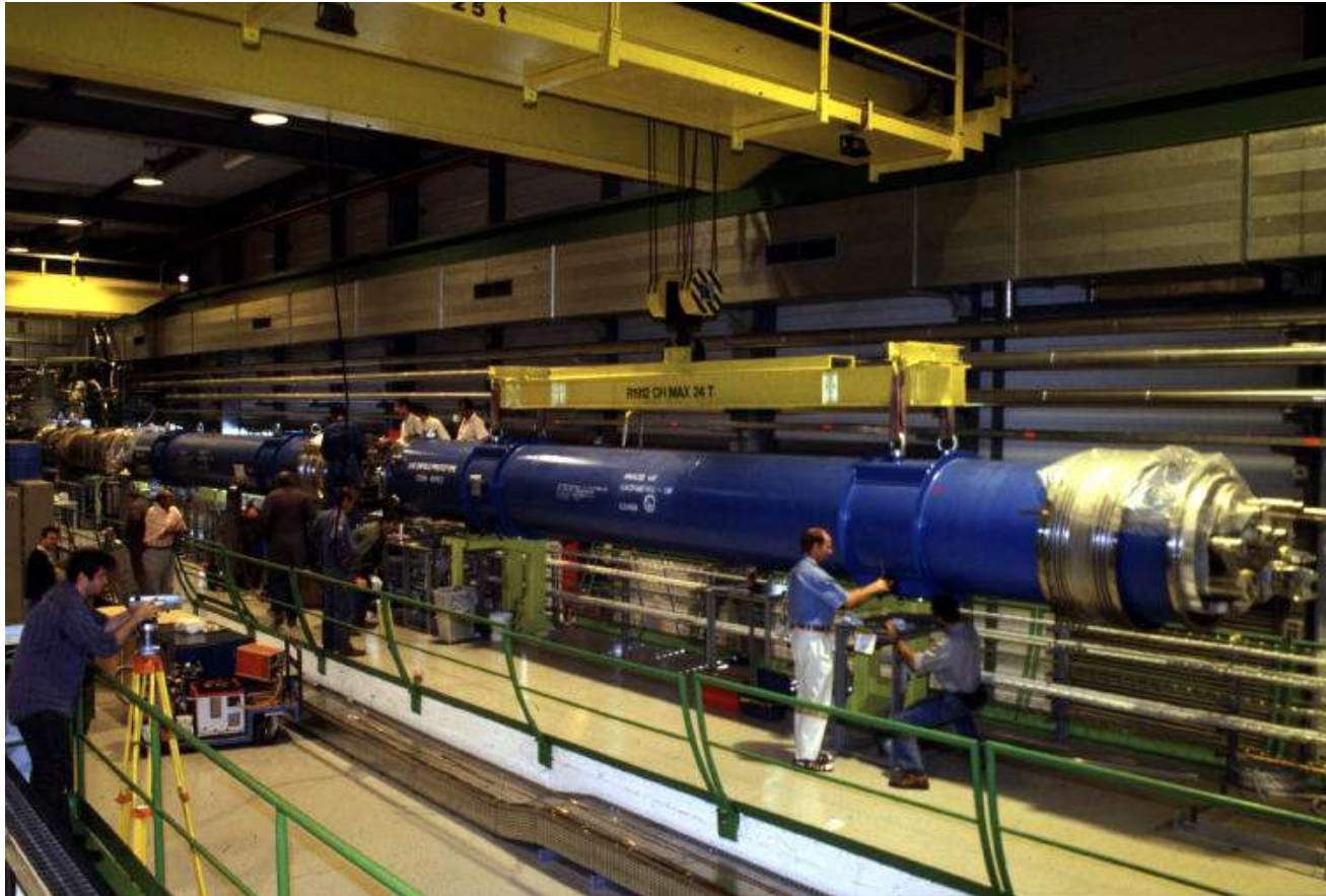
Magneti superconduttori al CERN di Ginevra
